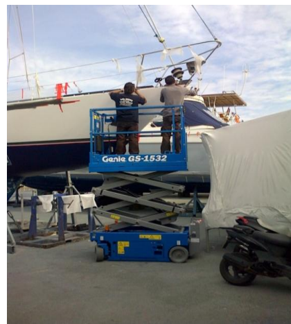
Nacelle pour le travail en hauteur
